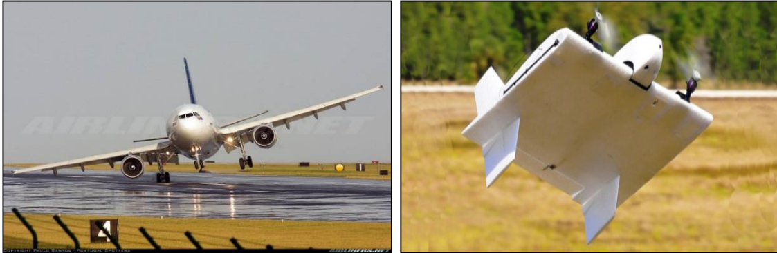
6.11. kép Intenzív szélnyírás okozta egyensúlyvesztés. Balra: utasszállító gép leszállás közben. Jobbra: UAV eszköz leszállás közben 341
