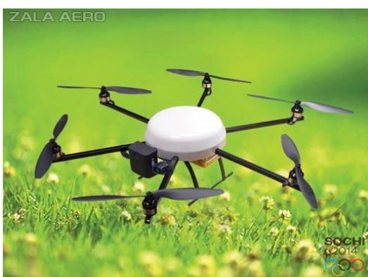
2.28. kép Hatrotoros VTOL mini-UAV ZALA 421–21 151
