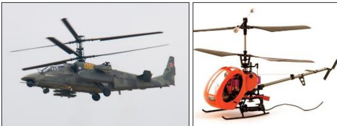
2.20. a-b kép Koaxiális rotorú VTOL repülőgépek 139
