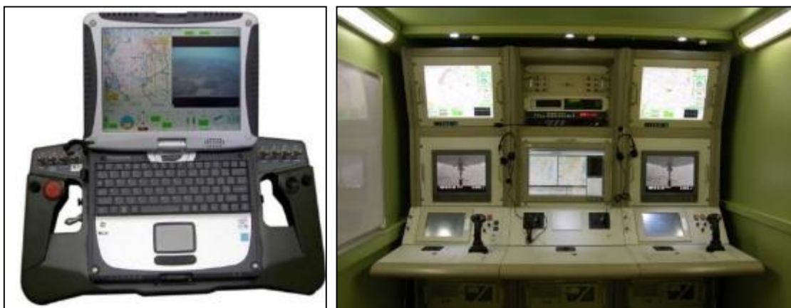
4.26. kép Nyílt terepen használatos és egy konténerbe telepített irányító/értékelő állomás 269,270
