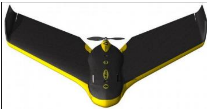
4.16. kép Az „eBee” 96 centiméter fesztávú és 630 gramm tömegű 258
