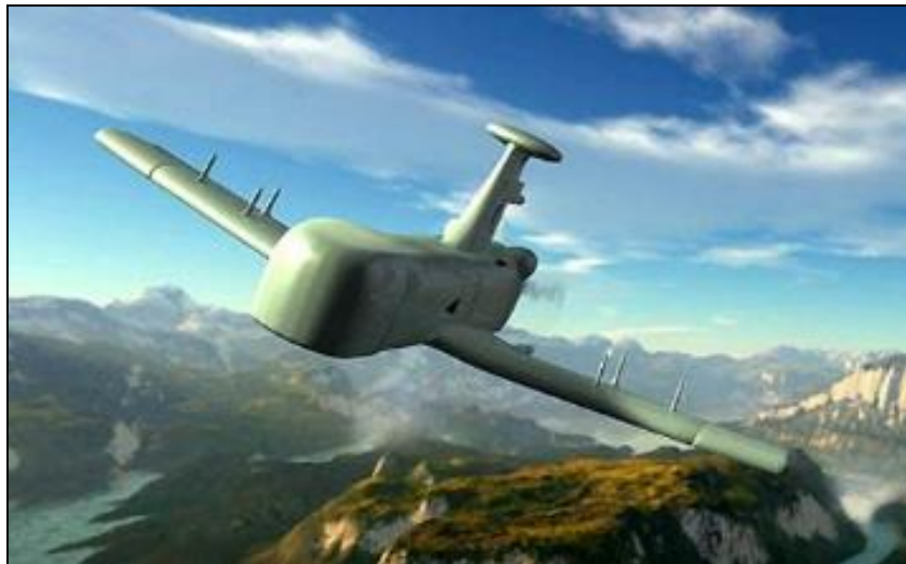
4.32. kép A Rheinmetall KZO „Fledermaus” ESM – elektronikai támogatás felszereléssel 278
