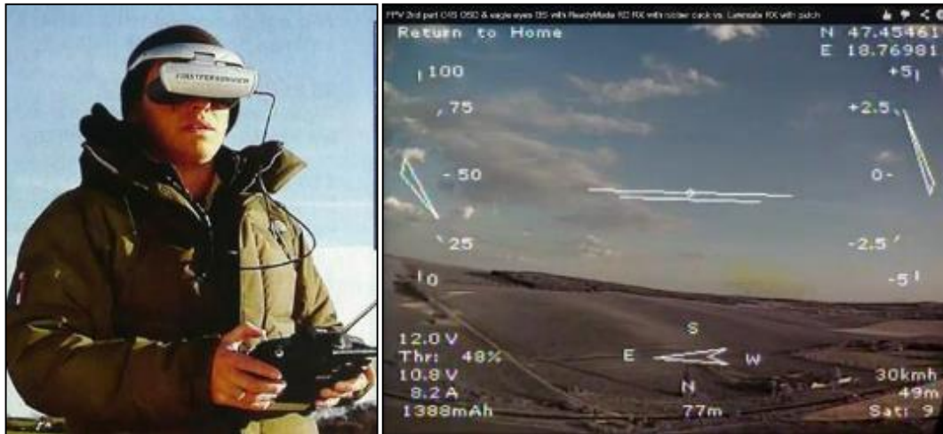
4.27. kép Az FPV szemüveg és a repülés adatai az OSD képen (YouTube) 271,272
