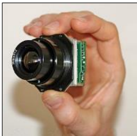
4.10. kép A Thermoteknix's MicroCam kamerája mindössze 1W fogyasztású 249
