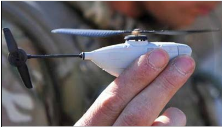
4.3. kép A Black Hornet Nano 16 gramm – kamerával együtt 239
