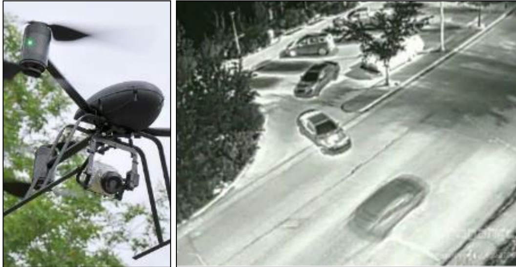
4.11. kép A DraganFlyer X6 hexacopter fedélzetén működő FLIR TAU kamera és az általa készített hőkép 250
