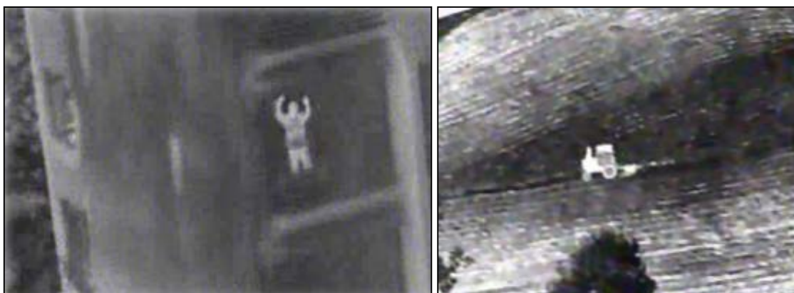
8.13. kép UAV által készített hőkamerás felvételek. Ember és jármű észlelése 408
