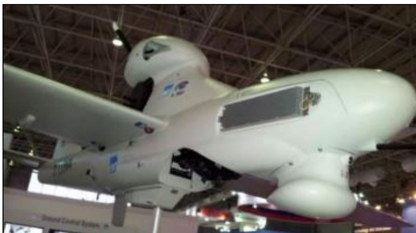
4.33. kép Az EMT „Luna” a Lima-2013 kiállításon – jól látható a SAR elhelyezése 279
