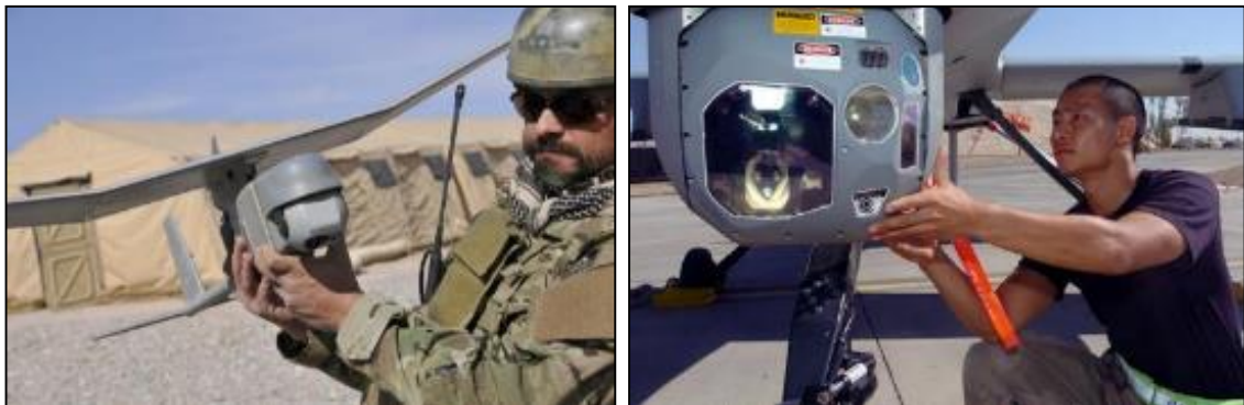
4.6. kép Stabilizált multiszenzorok a Raven és a Predator fedélzetén 242,243
