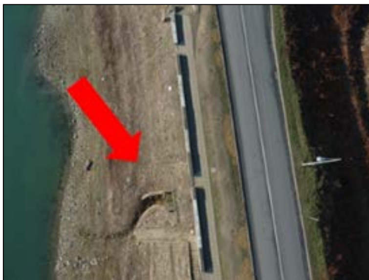
8.55. kép Egy javításra szoruló áteresz egy település belterületén UAV-vel észelve 450
