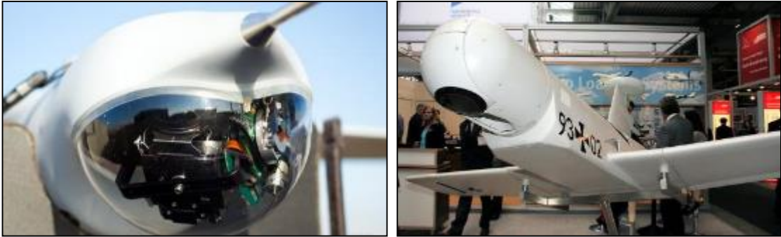
4.8. kép A Scan Eagle 246 és a KZO 247 elektrooptikai rendszerének védelme
