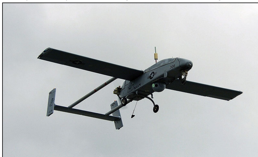
2.40. kép Kétütemű kéthengeres dugattyús motorú RQ-2B Pioneer 171
