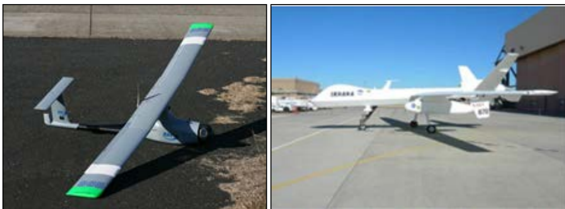
8.13. kép Határőrizeti feladatok ellátására is alkalmas UAV-k. Balra: a magyar gyártmányú taktikai BXUAV, jobbra egy átalakított Predator 407
