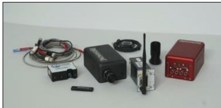
4.15. kép A Resonon hiperspektrális képalkotó rendszer fedélzeti egysége 257
