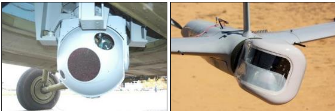
4.12. kép Az Aeronautics Aerostar és Orbiter repülőgépeinek látható és infra tartományban működő kamerái 251,252
